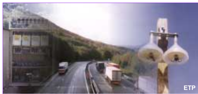
Montage montrant à gauche les préleveurs séquentiels et à droite les capteurs passifs
